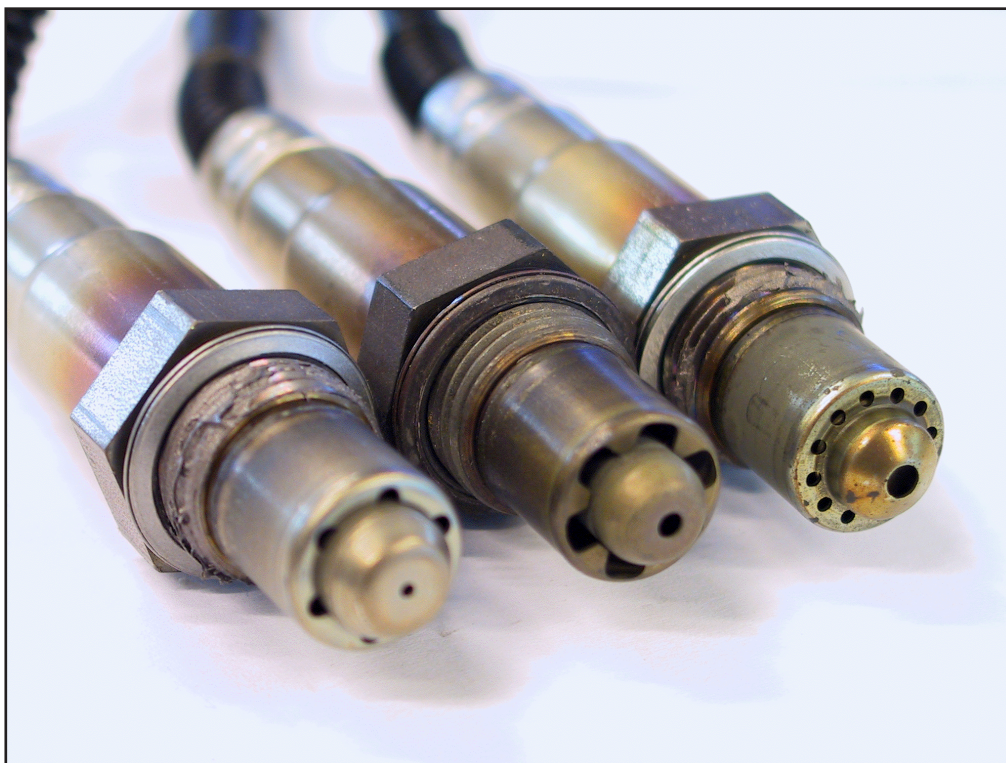
Kuva-8 Lambda-anturin erilaisia suojakuoria
